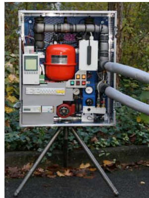
Le mini-module de TRT développé par l'EPFL
